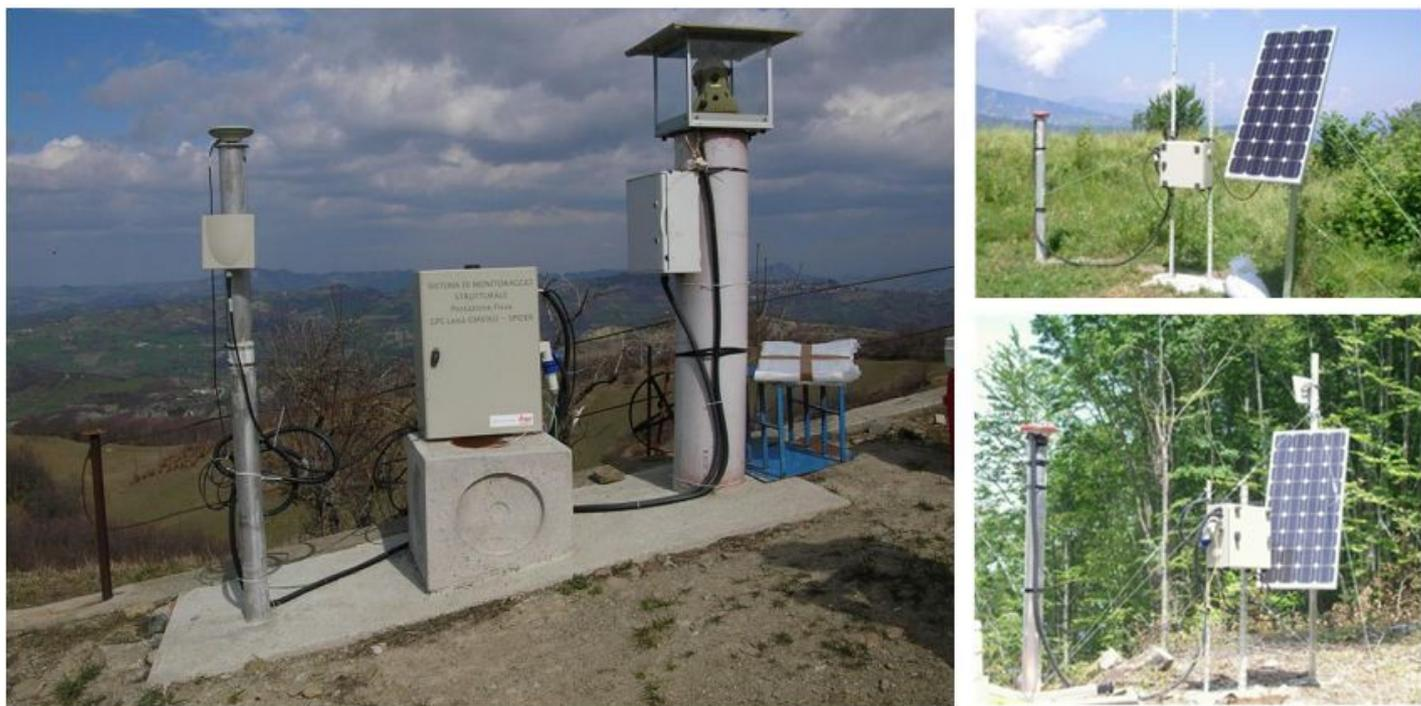
Figura 1. Frana di Valoria (MO): postazione master del sistema di monitoraggio continuo e materializzazione dei GPS rover in frana.
