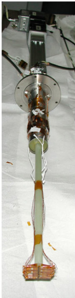
Figura 3 - Discendente con dispositivo per il montaggio delle sonde di Hall. Il supporto delle sonde viene movimentato mediante un attuatore lineare avente una risoluzione di 1 \mu\text{m} e una corsa di 100 mm.
